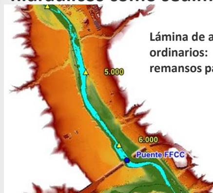
Lámina de agua para los caudales ordinarios: Verificación de remansos para  $Q(50\%) = 0,9 \text{ m}^3/\text{s}$
