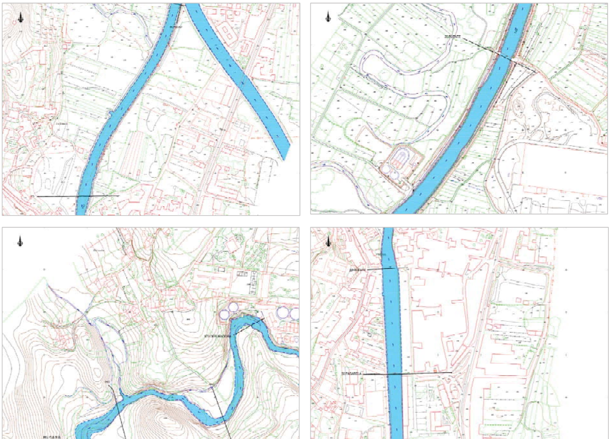
Tramos modificados por presiones antrópicas sobre el río Sar: Desvío de cauce (I), tramo acortado (II), tramo simplificado (III) y tramo canalizado (IV).
