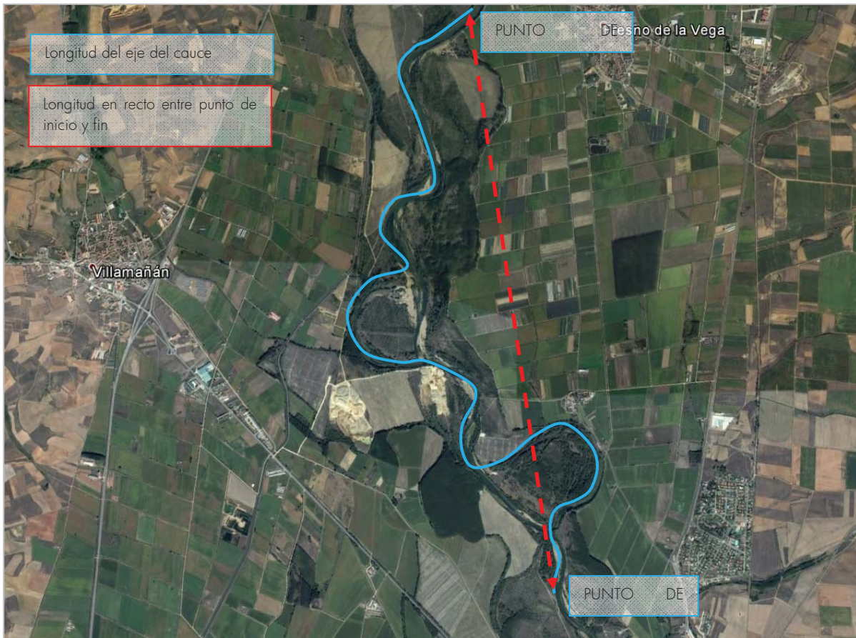
Determinación del Índice de sinuosidad de un tramo del río Esla.
