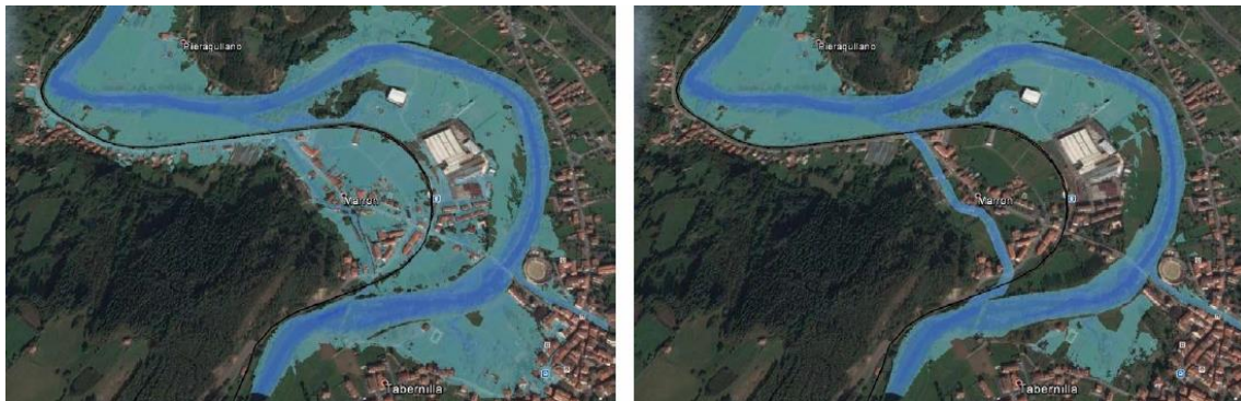
Fig. 16: T=100 estimado antes y después de la intervención. Estudio de soluciones de mitigación de la inundabilidad en el Polígono Industrial de Marrón. Instituto de Hidráulica Ambiental. Universidad de Cantabria.
