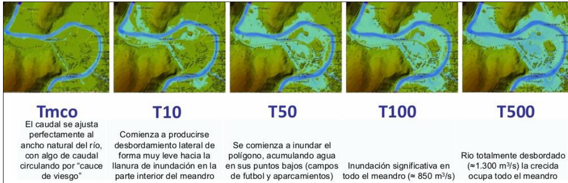
Fig. 15: Máxima crecida ordinaria y escenarios T10, T50, T100 y T500. Estudio de soluciones de mitigación de la inundabilidad en el Polígono Industrial de Marrón. Instituto de Hidráulica Ambiental. Universidad de Cantabria.
