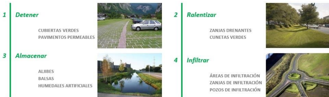
Fig. 53: Tipología de SUDS. Guías de adaptación al riesgo de inundación: sistemas urbanos de drenaje sostenible. 2019.
