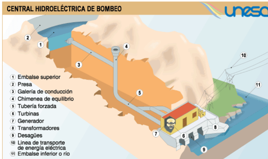
Ilustración 3: Central hidráulica de bombeo.
