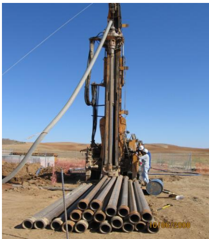
Ilustración 2: Máquina de perforación por el sistema de roto percusión y ensayo de bombeo
