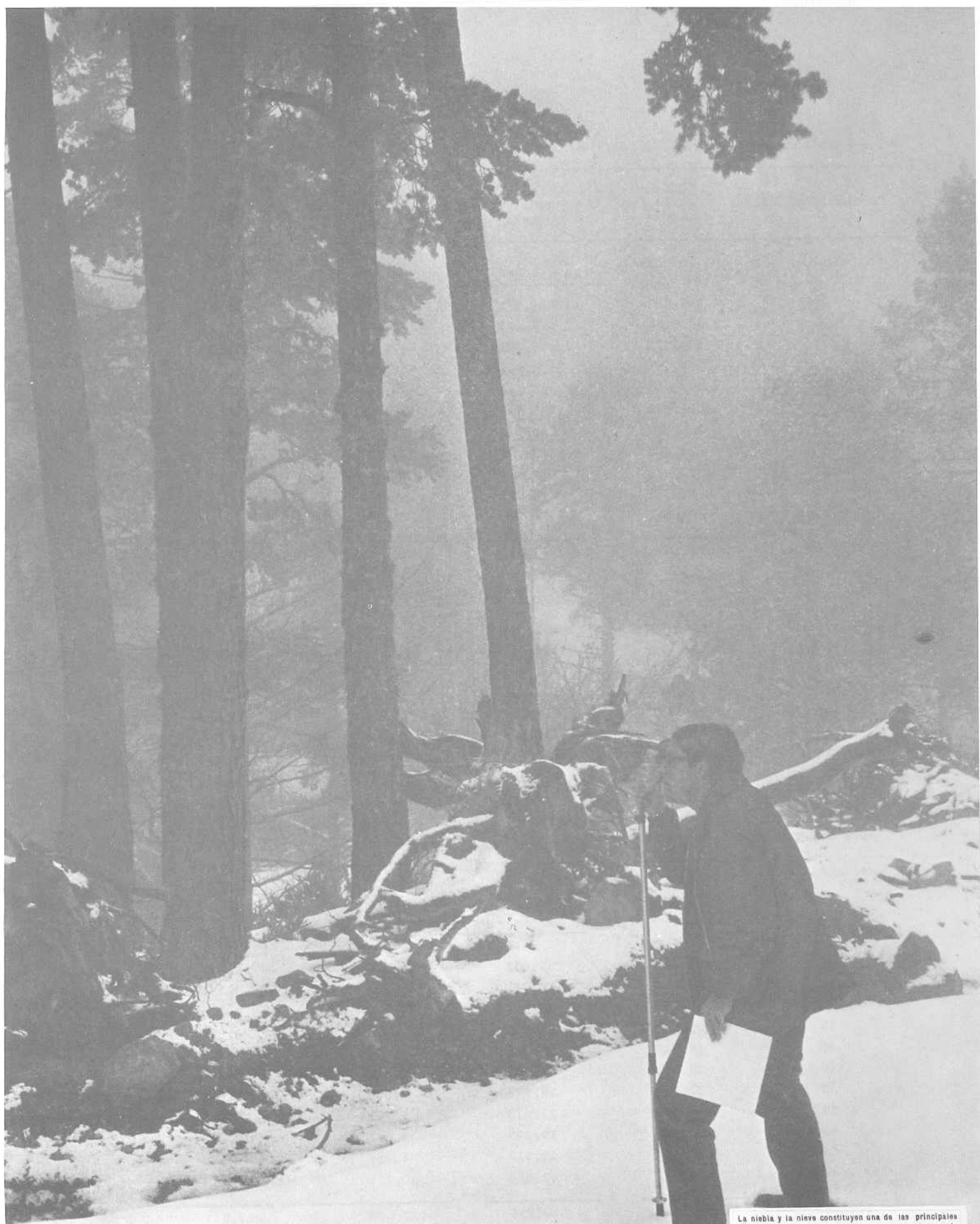
La niebla y la nieve constituyen una de las principales dificultades en los trabajos de campo del Inventario Forestal Nacional. Utilización del relescopio para medir las alturas de los pies de Pinus silvestris a 1.800 mts. de altitud en los Picos de Urbión. (Soria)
