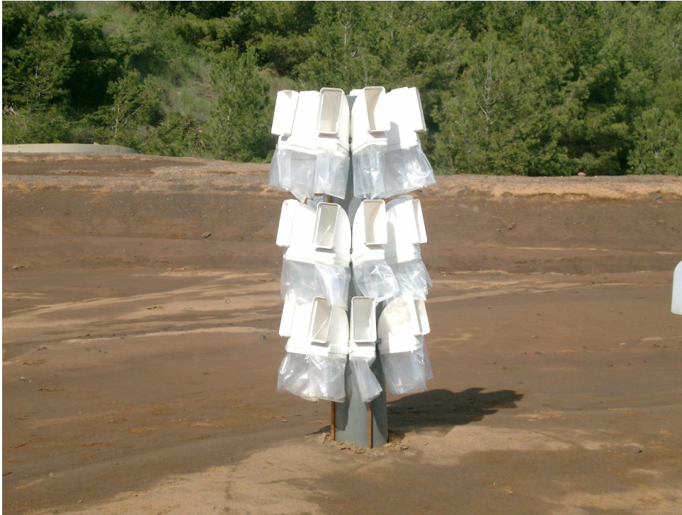
Vista del multicolector de erosión eólica.
