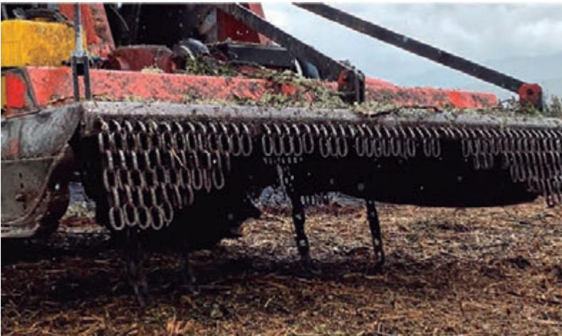
**Figura 77.** Detalle de apero de cadenas acoplado a un tractor para ejecución de desbroce mecanizado. Foto: Pablo Martín-Pinto.
