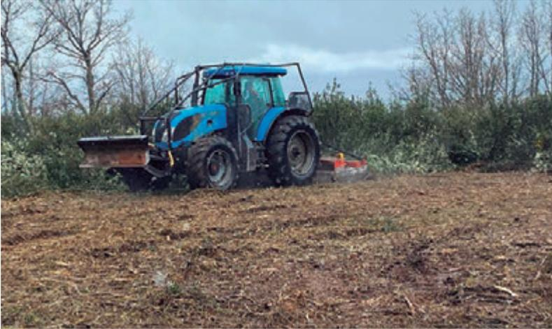
**Figura 76.** Detalle de un desbroce total ejecutado con una desbrozadora de cadenas acoplada a un tractor agrícola. Foto: Pablo Martín-Pinto.
