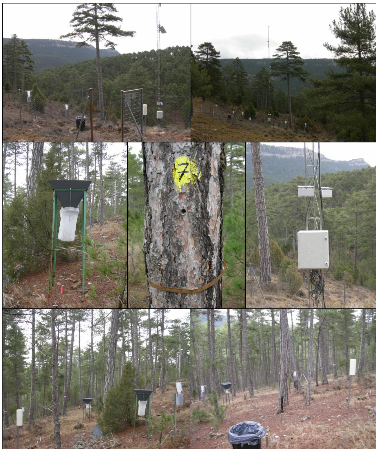
FIG 7: Parcela exterior. Captador de desfronde. Cinta diámetrica y árbol de evaluación fenológica. Data-logger y dosímetros. Captadores parcela interior
