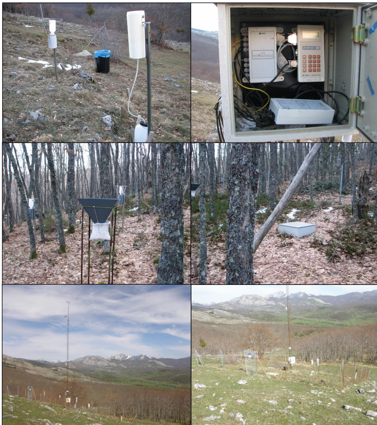
FIG 7: Parcela exterior. Captadores. Data-logger. Parcela interior. Acumuladores de deposición, captador de desfronde, caja de lisímetros. Parcela exterior y torre meteorológica.
