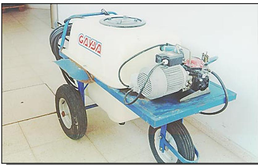
Figura 11: Cuba para la aplicación de productos fitosanitarios.
