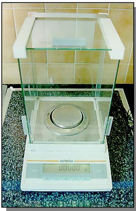
Figura 14: Balanza digital de precisión.
