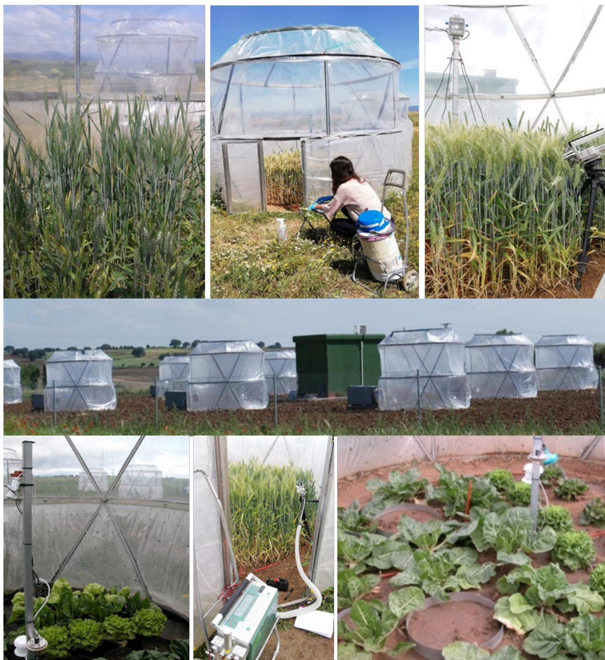
Figura 14. Instalación experimental de Cámaras Descubiertas del CIEMAT ubicada en la Finca de Experimentación Agraria de La Higuera (MNCN/CSIC). Detalles de los ensayos realizados con trigo y cultivos de hoja. Fuente: CIEMAT
