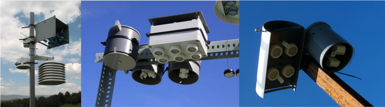
Figura 16. Dosímetros pasivos para medida de contaminantes gaseosos. Distintos modelos de dosímetros para el análisis de los niveles de ozono y óxidos de nitrógeno. Fuente: CIEMAT, CEAM, MITECO.
