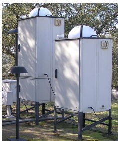
Equipos de recogida de agua de lluvia
