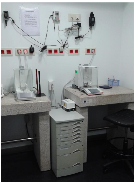
Imagen 13. Sala de balanzas del LMAG con temperatura y humedad controladas.
