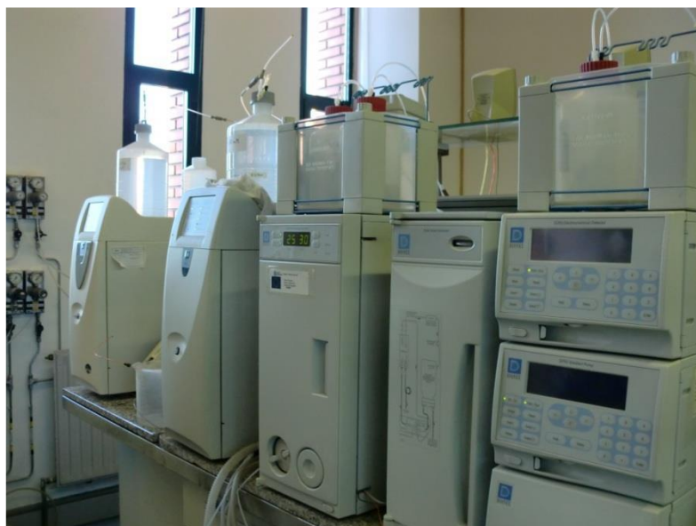
Imagen 14. Cromatógrafo iónico Dionex ICS1000 del LMAG.
