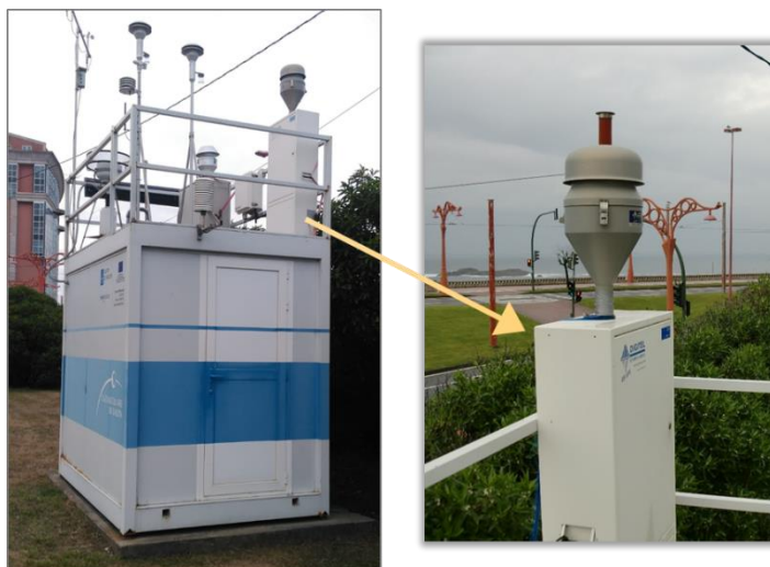
Imagen 12. Captador Digital DHA-80 instalado en Torre de Hércules para muestreo de PM10.
