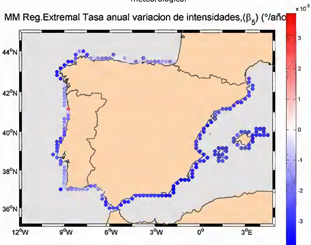
Figura 22 Resultados del análisis de tendencias del régimen extremal de Intensidades de marea meteorológica.
