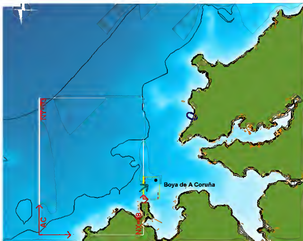
Figura 2.5. Mallas de propagación de la zona correspondiente a la boya de A Coruña.
