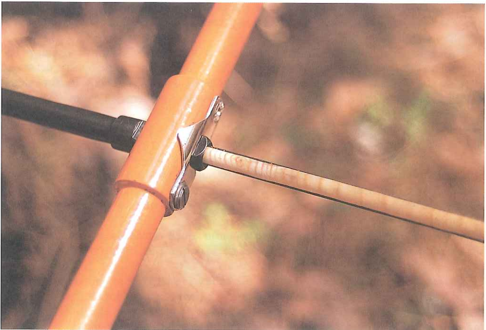
Medición de la edad mediante la extracción de muestras de crecimiento con la bórrena de Pressler
