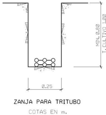
**Ilustración 3. Esquema de la zanja para tritubo a construir (Fuente: Telefónica de España SAU. Año 2022).**
