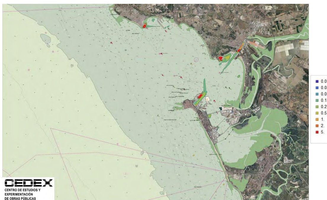
Figura 53. Densidad de fondeo en la bahía de Cádiz en 2018 (número de posiciones por km 2 , en tanto por uno con relación al número de instantáneas utilizadas) (Fuente: Elaboración propia a partir de datos AIS facilitados por SASEMAR).
