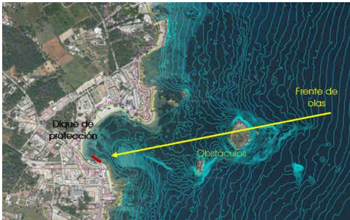
Ilustración 7 Posición del dique de protección y frente de olas
