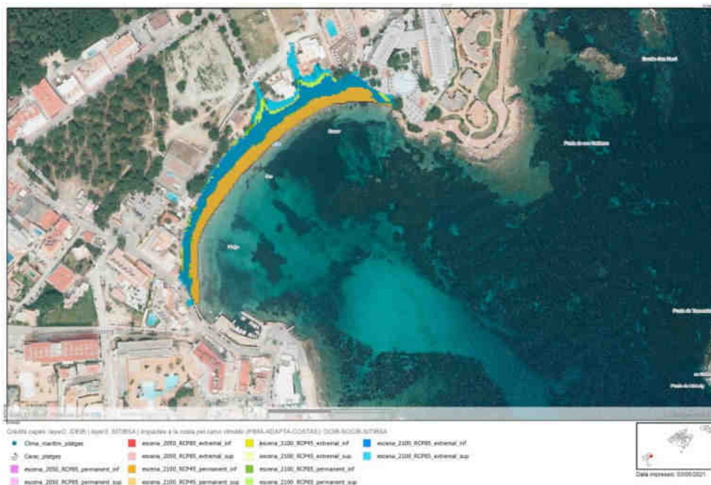
Ilustración 2 Alcance de inundación costero asociada a los diferentes escenarios de cambio climático y régimen extremal asociado.
