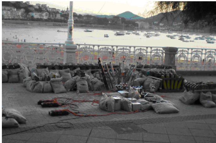
Ejemplo de fijación de la herramienta con sacos de arena
