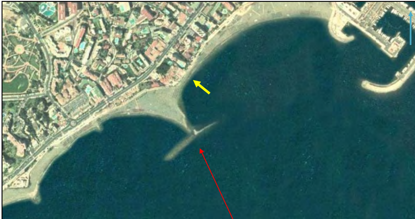
Año 1998. Se ha sustituido el campo de espigones por un gran dique exento entre las playas de Malapesquera y Santa Ana, con otro más pequeño frente a la punta del castillo del Bil-Bil
