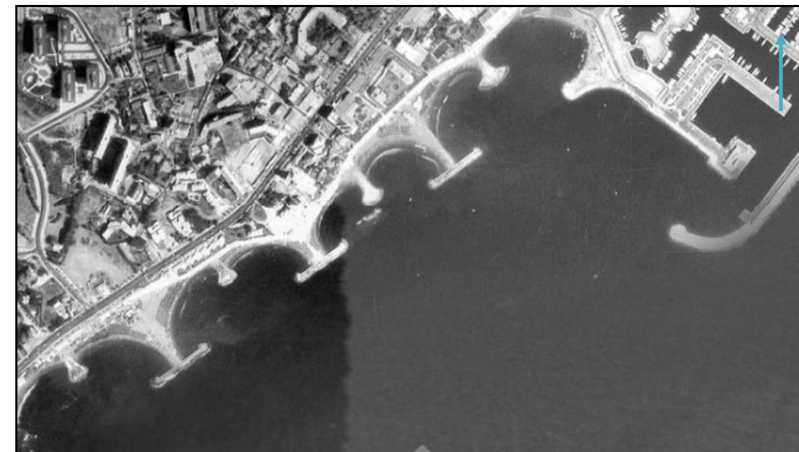
Mediados de los años 80. El puerto deportivo ya está construido. Existe un campo de espigones en T más desarrollado, con pequeños espigones intermedio antibasculamiento, lo cual indica que debían de ocurrir episodios fuertes de basculamiento en las celdas entre espigones, que provocarían zonas de acreción y erosión.
