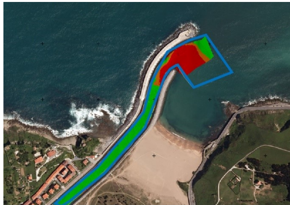
Figura 2. Zona externa del puerto de Zumaia. Situación de calados en el puerto de Zumaia en 24 de marzo de 2020 y polígono de dragado.
