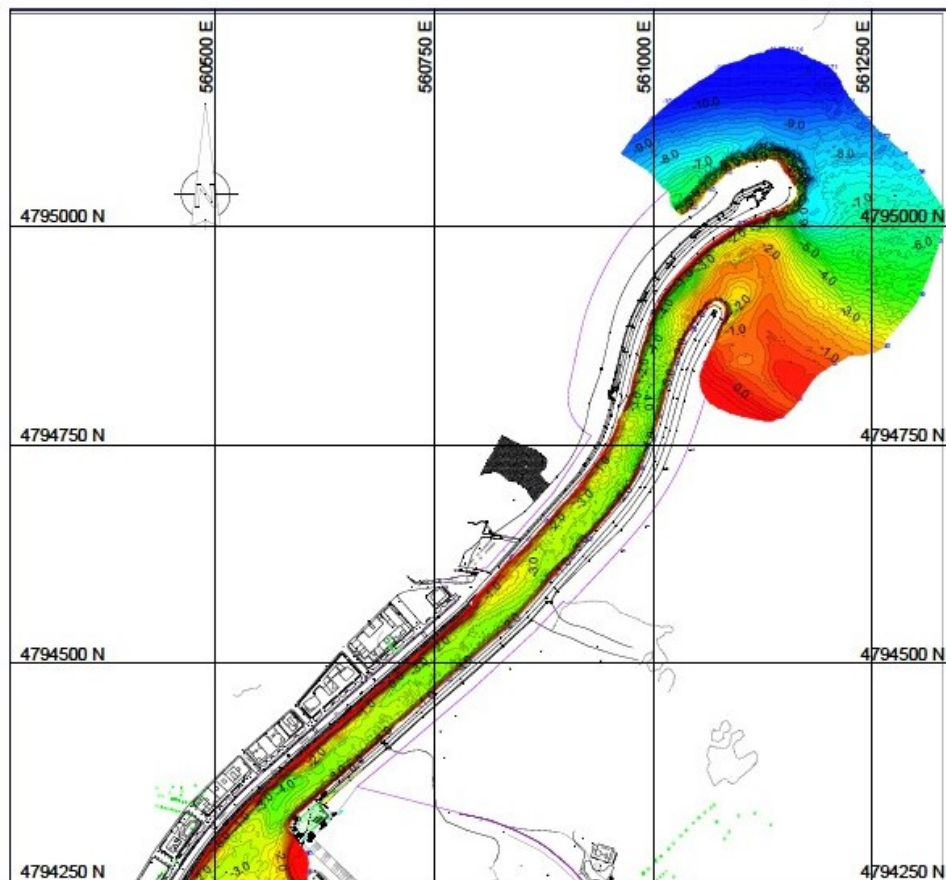
Figura 4. Batimetría realizada en abril de 2020 (véase ANEXO A, para mayor detalle). La zona de interés a dragar se localiza al norte de 4.794.750 m (UTM / ETRS89, huso 30N).
