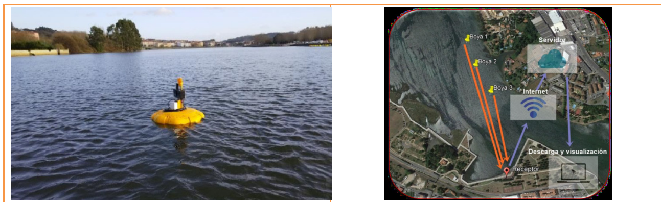
Figura 11 Instalación en fase de pruebas de boyas con sensores de medición de turbidez asociada a la ejecución de las obras del recinto de Oleiros.
