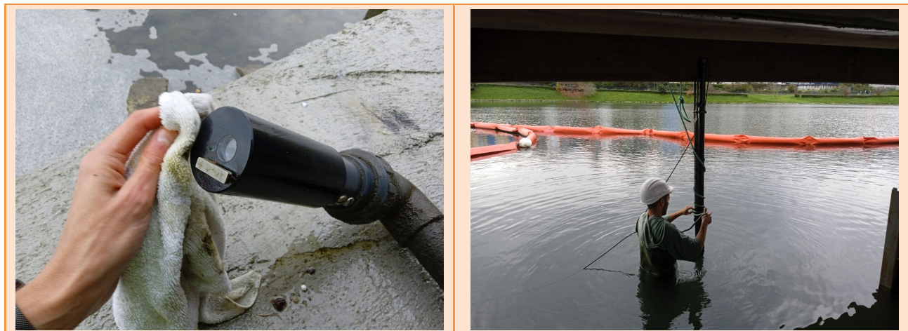
Figura 10 Mantenimiento del sensor de medición de turbidez en la laguna de Fonteculler.
