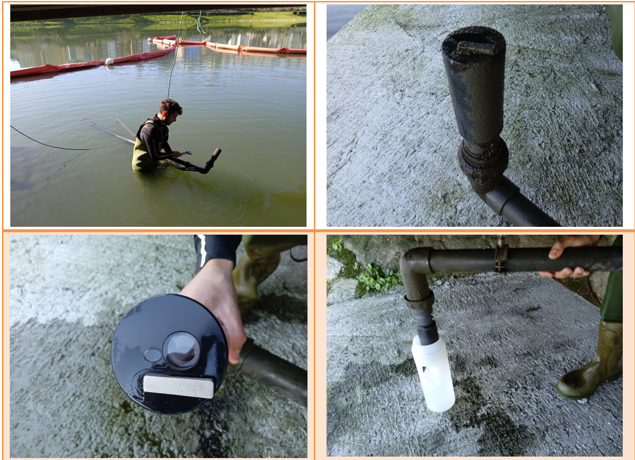
Figura 9 Mantenimiento del sensor de medición de turbidez en la laguna de Fonteculler.
