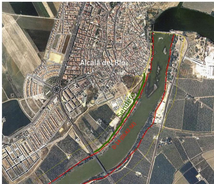
La Intervención contempla el desbroce, compactación de terreno existente, extendido y compactación de firme de albero con un espesor de 10 cm. La actuación se completa con 130 m. de talanquera.
