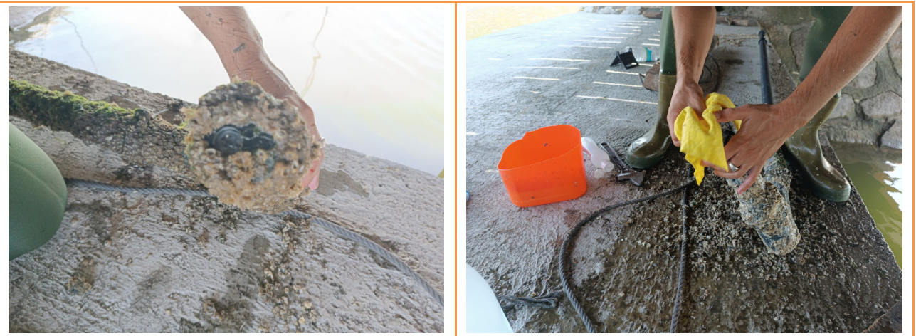
Figura 10 Limpieza del sensor en la laguna de Fonteculler. 22.08.2023
