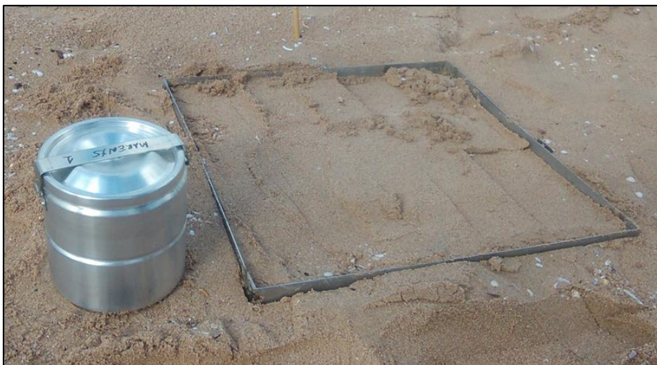
Figura 2 Marco metálico y contenedor utilizados en el muestreo
