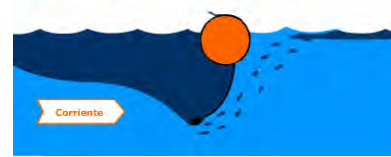
FALLO DE DRENAJE
