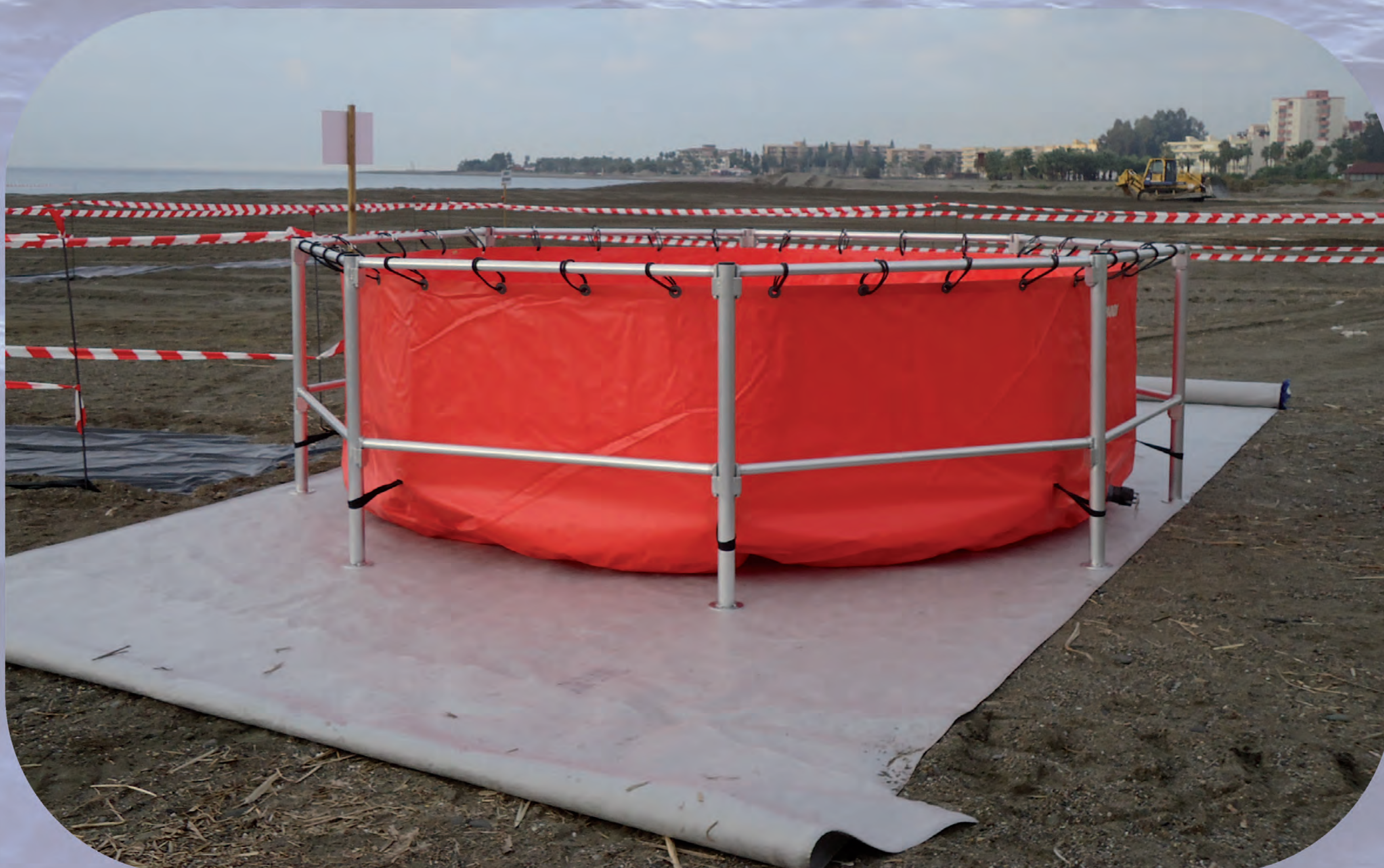
DEPÓSITOS DE ALMACENAMIENTO DE RESIDUOS
