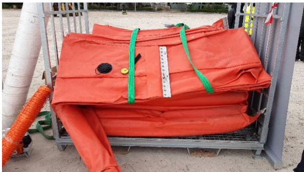
Ilustración 3. Barreras cilíndricas y selladoras en jaulón de almacenamiento.
