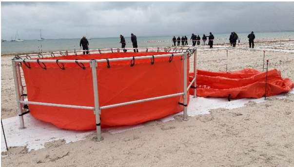
Ilustración 9. Fast Tank y tanque autoportante.
