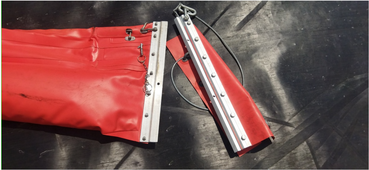
Ilustración 23. Muestra de barrera cilíndrica con conexión ASTM y adaptador ASTM-Noruega.
