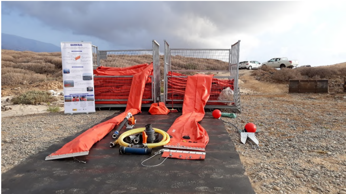
Ilustración 14. Material empleado para la charla formativa de las barreras de contención.
