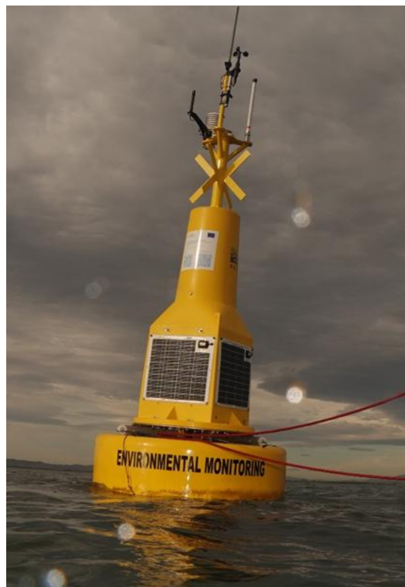
Figura 2: Boya piloto de monitorización SMARTLAGOON.
