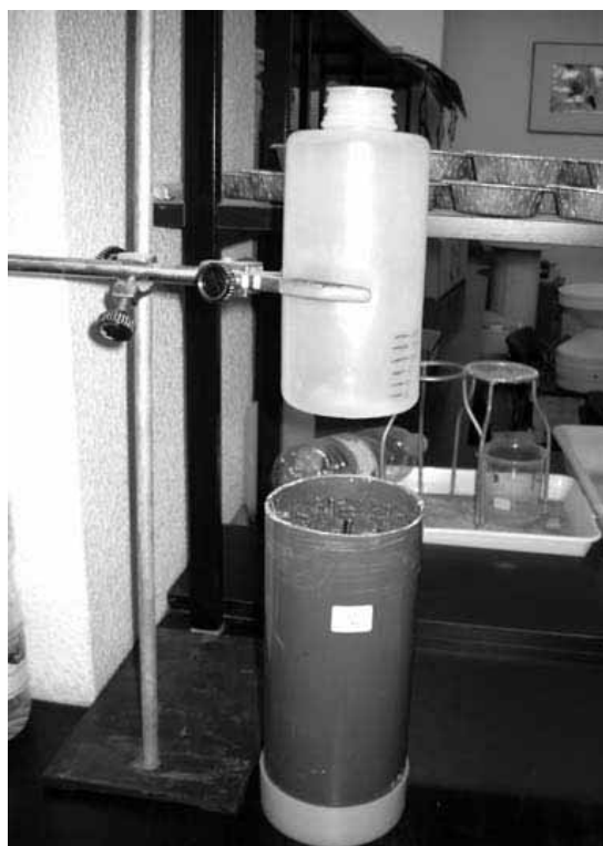
Figura 2. Cilindro de suelo sin alterar para la obtención de las ecuaciones de conversión humedad - precipitación.
