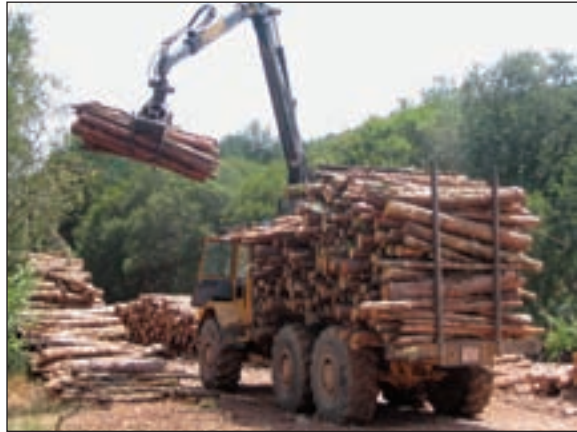
Figura 3-26. Autocargador, cargando troncos cortados para su traslado a camiones.
