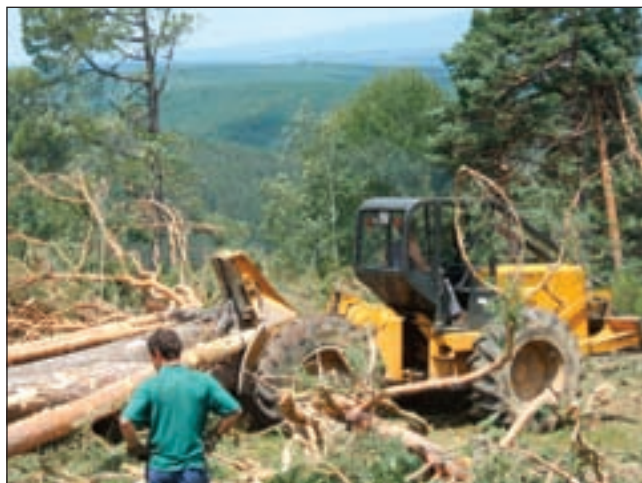
Figura 3-19. Tractor forestal ( skider ) moviendo troncos cortados para su transporte.
