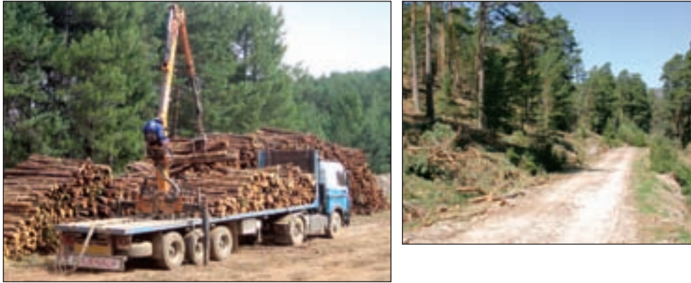
Figura 3-15. Carga de camión de transporte de troncos mediante grúas especializadas (izquierda). Pista de acceso de maquinaria y personal para las tareas de aprovechamiento maderero en pinar (derecha, Javier de la Puente. SEO/BirdLife. P. N. Peñalara).
