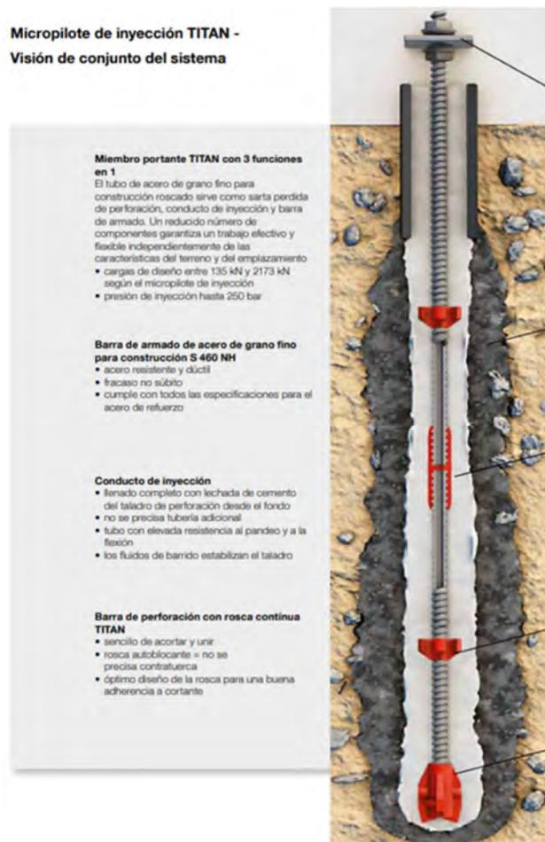
**Fig. 1.** Partes del micropilote TITAN
