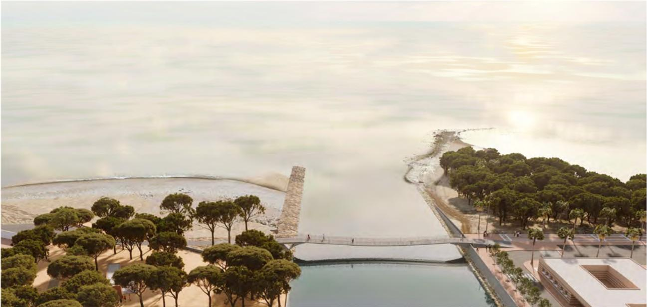
Se trata una pasarela en banda tesa, de un solo vano de aproximadamente 50 m de luz entre puntos de inflexión del alzado de la pasarela. No cuenta con pilas intermedias en el cauce.
