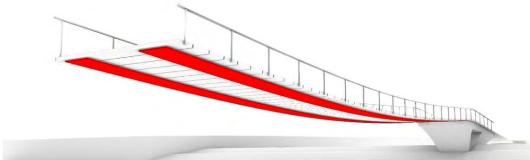
Siendo  $t_{banda}$  el espesor de cada una de las bandas, y  $w_{banda}$  el ancho de cada una de las bandas, el peso propio de una banda es:
