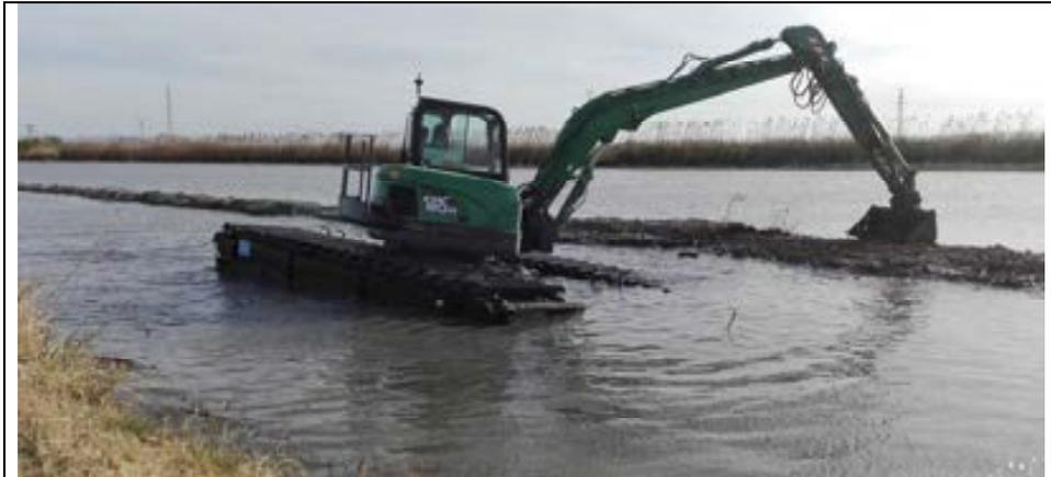
*-Excavadora anfibia EIK AM-80, maquinaria apropiada para labores de limpieza y sobreexcavación de las acequias.*
