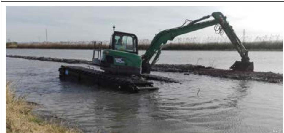
*-Excavadora anfibia EIK AM-80, maquinaria apropiada para labores de limpieza y sobreexcavación de las acequias.*
