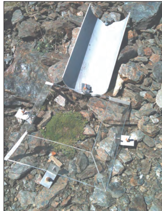
Figura 3. Cámaras abiertas para simular los efectos del cambio climático sobre A. tetraquetra y sus especies asociadas en Sierra Nevada. Las cámaras aumentan la temperatura del aire 1,5-2,0 °C y se usan junto a un aumento o una disminución de la precipitación media del 30%, siguiendo los pronósticos de los modelos climáticos para mediados de siglo. (Foto: F.I. Pugnaire.)
