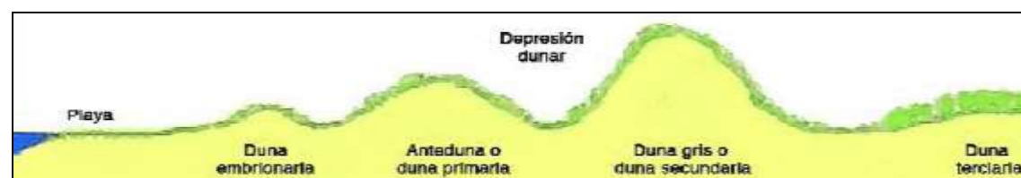
Corte transversal típico de un sistema dunar costero. Fuente: “Manual de restauración de dunas costeras”, MMA, septiembre 2007.
