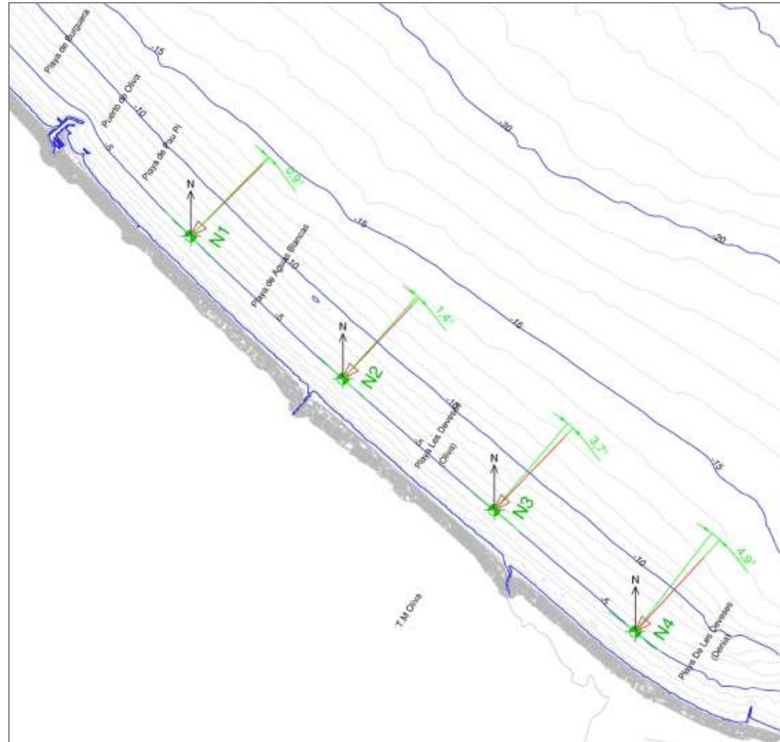
Figura 2. Dirección del FME en los Nodos 1 a 4 (en rojo) y ortogonal a la orientación de la costa (en verde).
