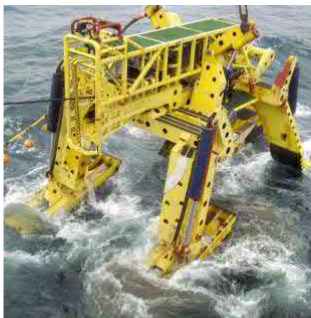
Figura 3.4-2: Arado - Sea Stallion 3 (izq.) y esquema de la vista frontal de arado (dcha.) (Fuente: SubCom, 2020).
