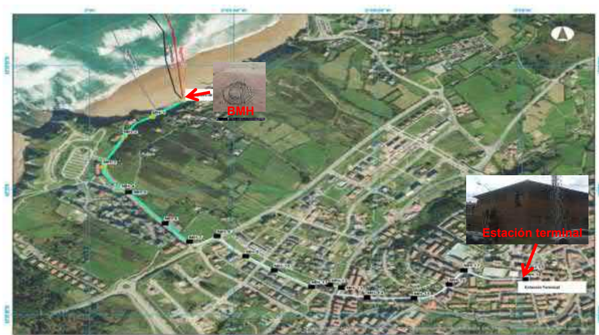
Figura 3.2-12: Ruta terrestre desde la arqueta de conexión (BMH) en la playa de Sopela hasta la Estación Terminal (Fuente: SubCom 2020).
