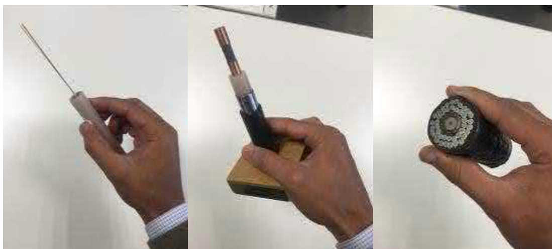
Figura 3.3-2: Imágenes de detalle de los cables que serán utilizados (LW, SPA y DA respectivamente de izquierda a derecha (Fuente: SubCom, 2020).
