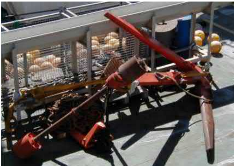
Figura 3.2-1: Rezón de excavación / Herramienta de recuperación de cables (Fuente: SubCom, 2020).
