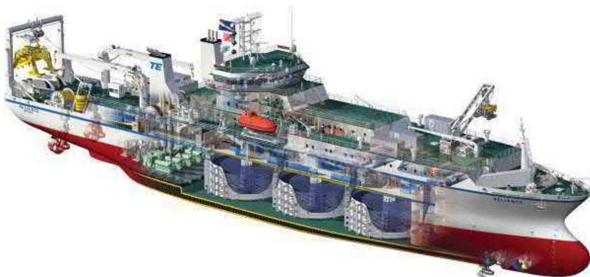
Figura 3.4-1: Esquema 3D tridimensional de un buque Reliance Class (Fuente: SubCom, 2020).
