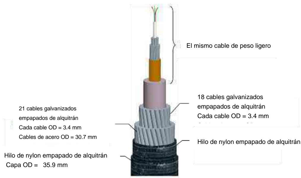
Figura 3.3-5: Cable doble armado SubCom S1L17 DA (Fuente: SubCom: 2020).
