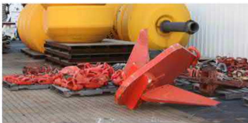
Figura 3.2-3: Rezón de limpieza de la ruta y equipo de recuperación de cables (Fuente: SubCom, 2020).
