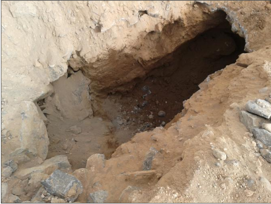
Fotografía 11: Calicata 3. Desprendimiento de cantos
