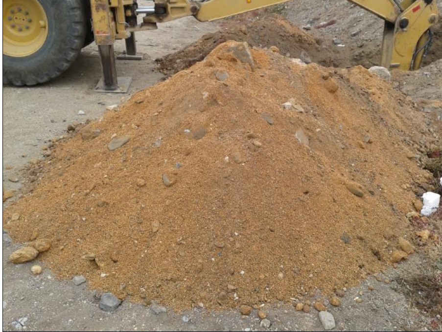
Fotografía 3: Arcillas arenosas en la calicata 1
