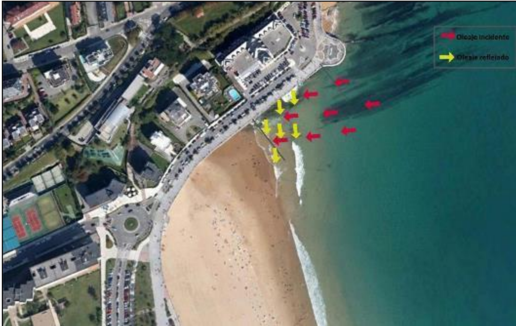
Ilustración 4. Representación del oleaje incidente y reflejado en el muro de la zona de estudio.
