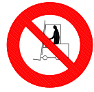
PROHIBIDO A LOS VEHICULOS DE MANUTENCION
