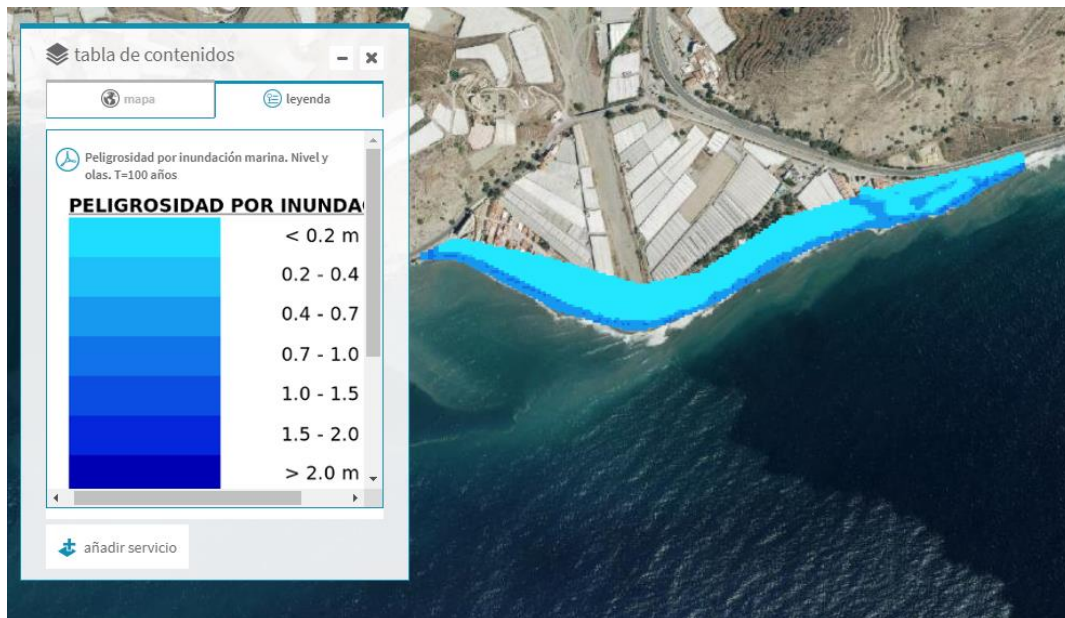
Ilustración 3.- Profundidad de inundación por encima del terreno asociado a periodo de retorno de 100 años. Fuente: MITECO
