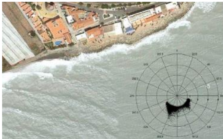
Ilustración 14 Oleajes registrado en boya Cabo de Gata, propagados hasta frente Castillo de Baños. Fuente: HIDTMA
