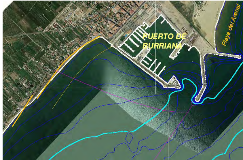
Figura 4.23. Orientaciones de la forma en planta de equilibrio estático en el tramo 1.
