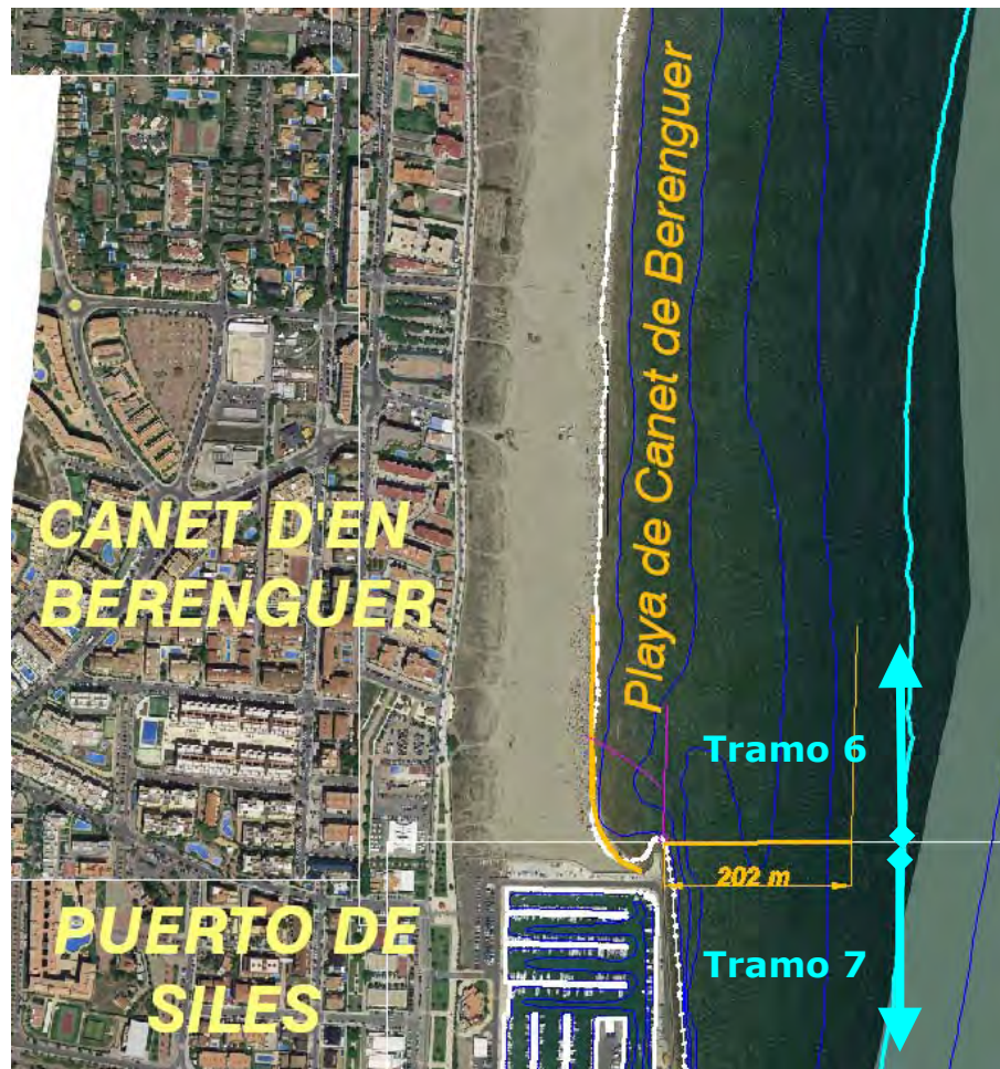
Figura 5.38 Ajuste de la planta actualmente existente y dique de separación de los tramos 6 y 7 de la alternativa 3.1.
