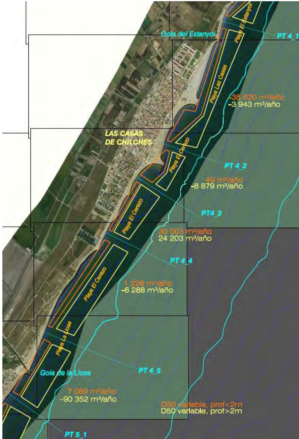
Figura 4.99. Balance sedimentario en perfil mixto diferenciando transporte en profundidad menor que 2 m y mayor que 2 m para la zona 4 (- significa pérdida de sedimento).
