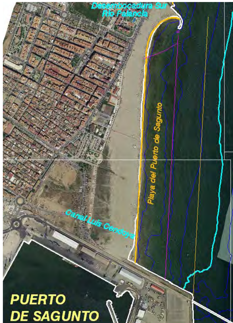
Figura 4.34. Forma en planta de equilibrio estático de la playa del Puerto de Sagunto.
