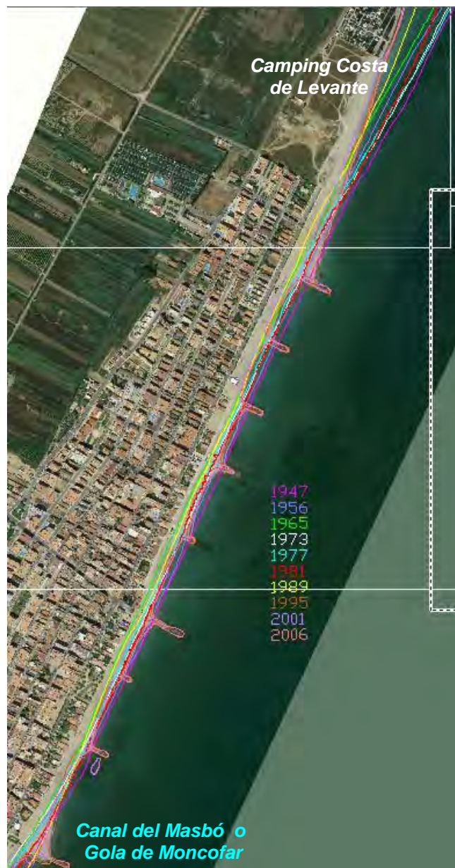
Figura 2.88 Líneas de costa históricas en la Playa de El Grau sobre fotografía de la situación actual (año 2009).
