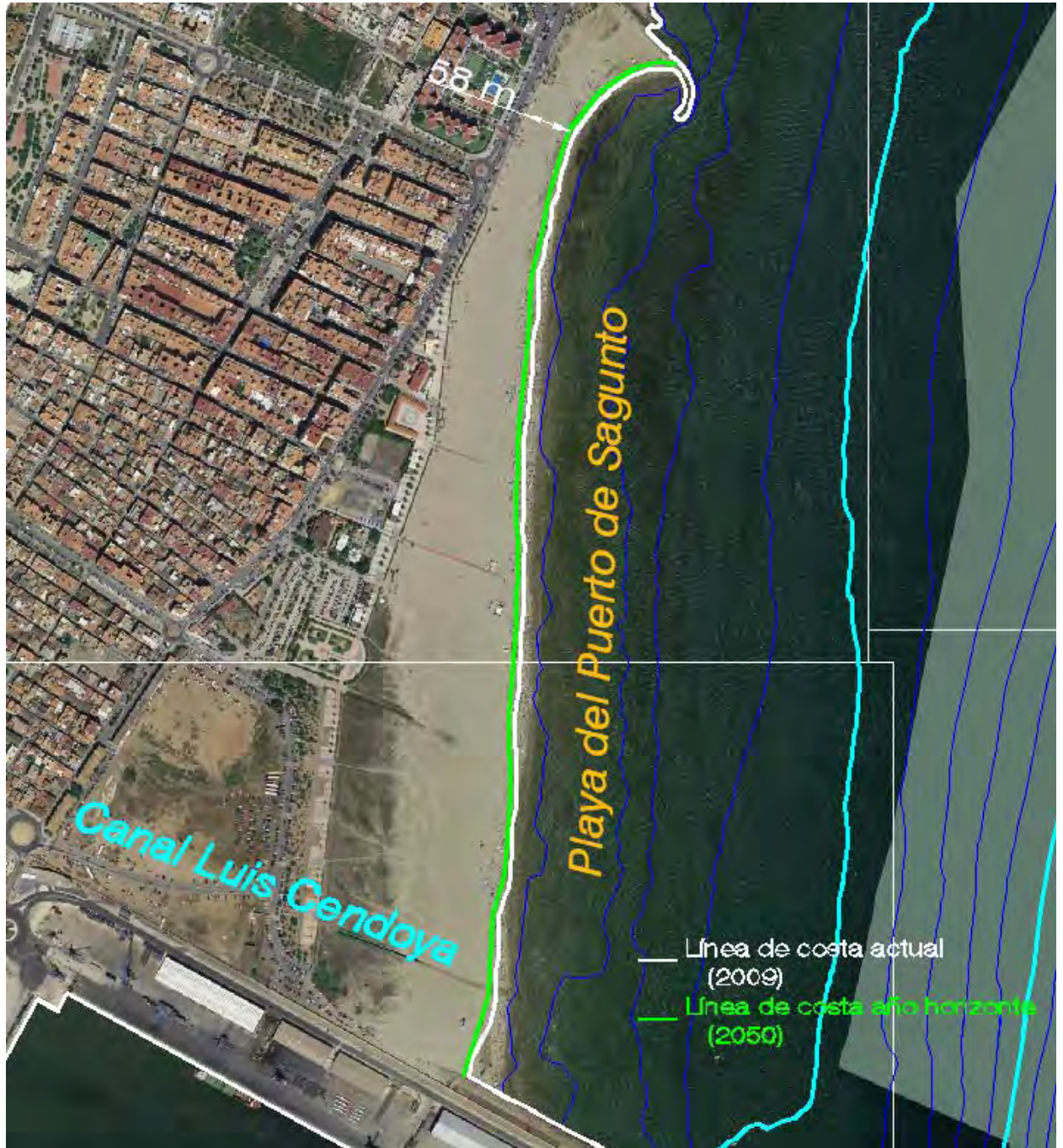
Figura 6.19 Línea de costa en el año horizonte (2050) en la Playa de Sagunto.
