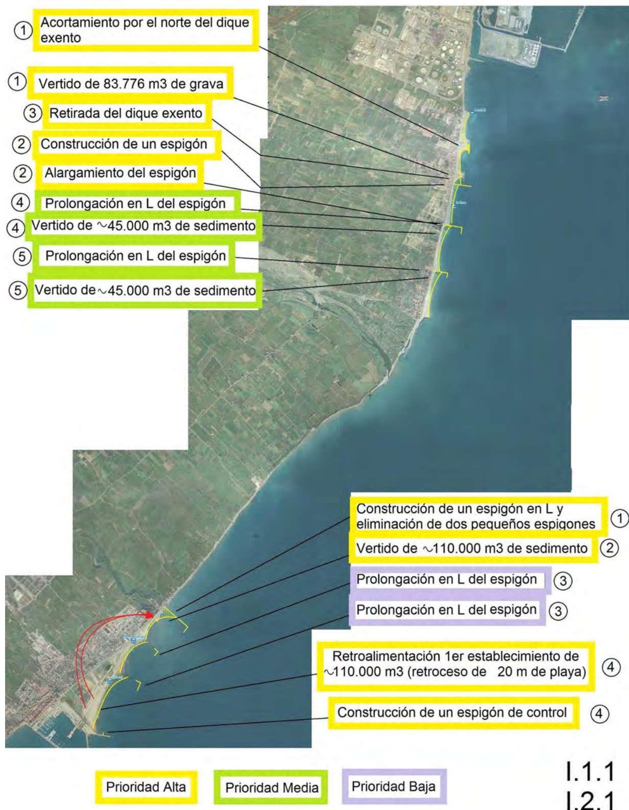
Figura 7.1: Prioridades de actuación del Tramo I: Puerto de Castellón – Puerto de Burriana (foto: DGSCyM)
