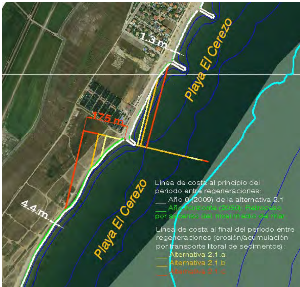
Figura 6.24 Retroceso de la línea de costa en torno al espigón de separación entre tramos de la alternativa 2.1.
