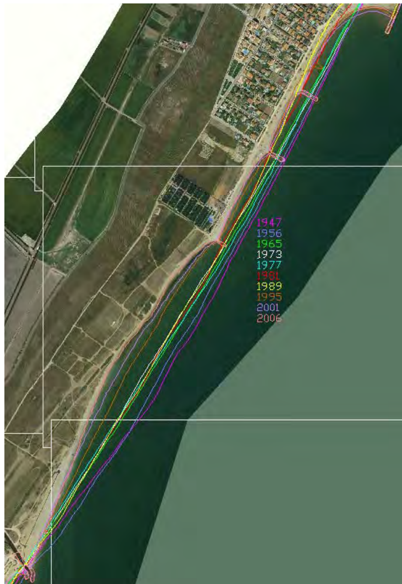
Figura 2.106 Líneas de costa históricas en las Playas del Cerezo Sur y la Llosa sobre fotografía de la situación actual (año 2009).
