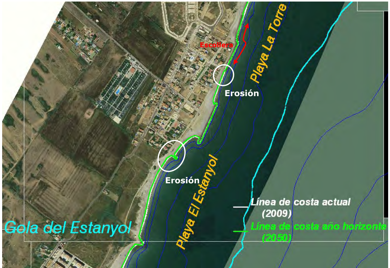
Figura 6.18 Retroceso de la línea de costa debido al ascenso del nivel medio del mar en la Playa de La Torre y El Estanyol.
