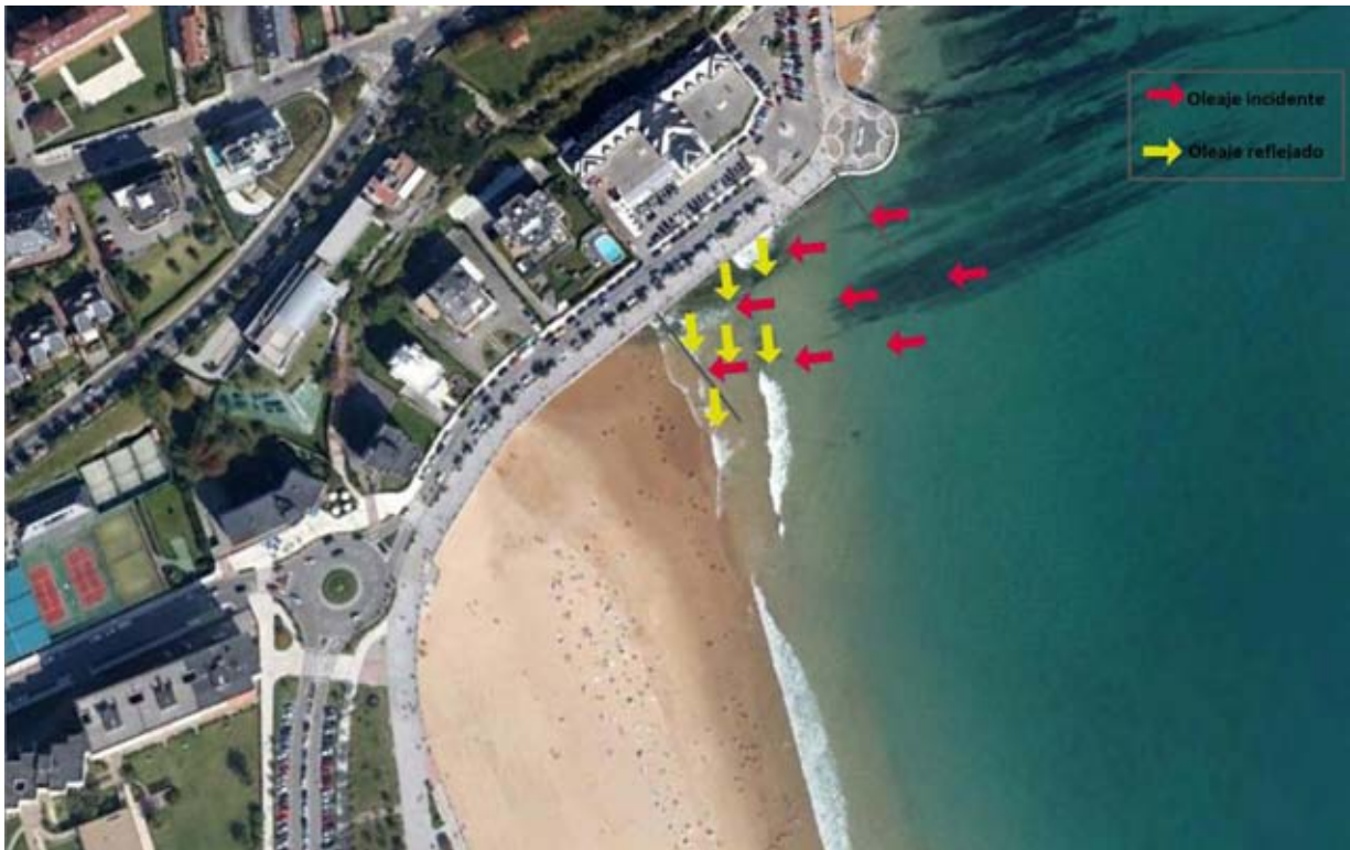
Ilustración 4: Representación del oleaje incidente y reflejado en el muro de la zona de estudio. Fuente: Google Earth
