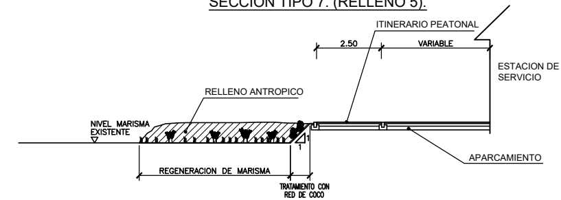
SECCION TIPO 7. (RELLENO 5).
