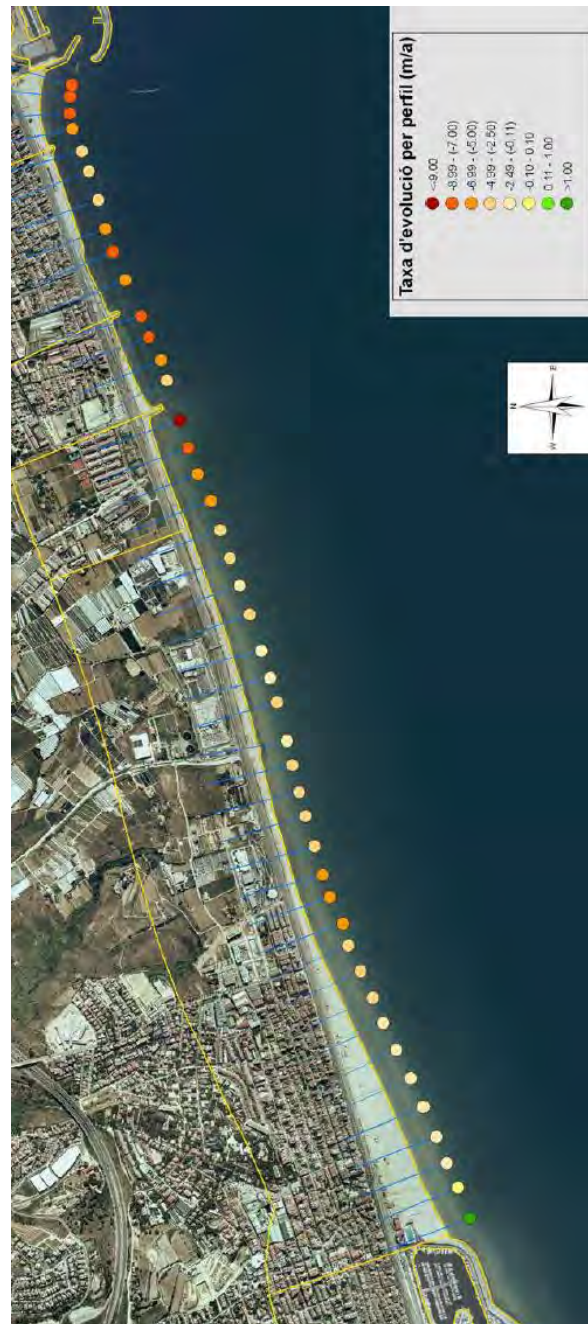
Figura 44.- Tasas de evolución histórica de la línea de costa en m/año (Fuente: CIIRC / Generalitat de Catalunya)
