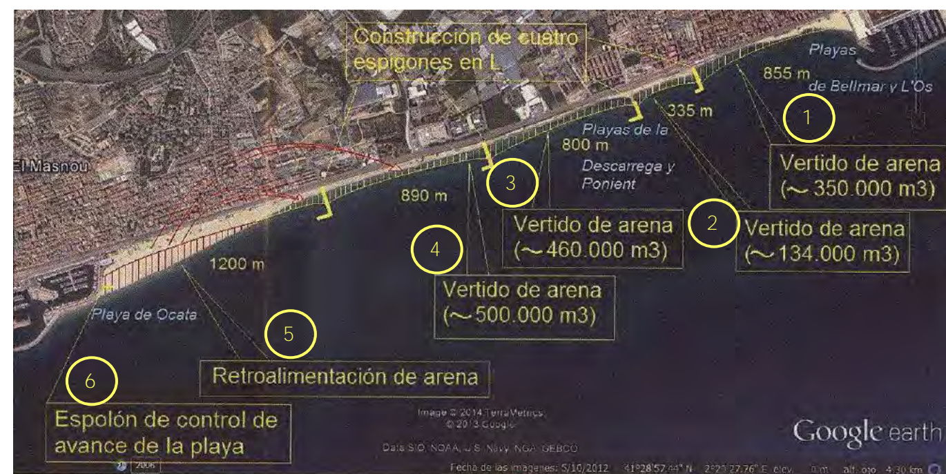
Figura 2.- Propuestas de actuación en el tramo entre los puertos de El Masnou y Premià sugeridas en el informe del CEDEX. (Fuente: CEDEX)
