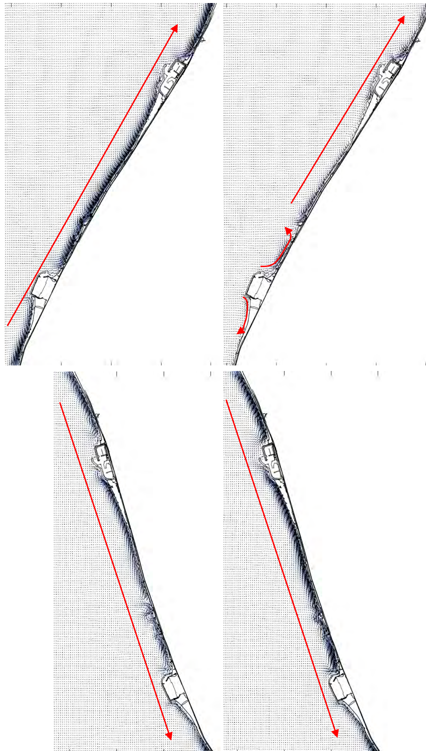
Figura 16.- Detalle gráfico de los vectores de corriente para los casos de H_{s,12} . De izquierda a derecha y de arriba abajo : E, SE, S y SSW. (Fuente: Elaboración propia)
