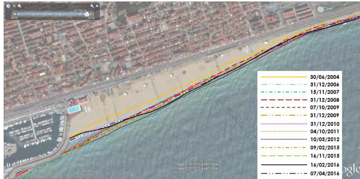
Figura 12.- Evolución de la playa apoyada en el dique del Puerto de El Masnou desde 2004. La posición tan retrasada de 2004 respecto a la de 2006 se explica por la regeneración realizada a finales de 2005 (Fuente: elaboración propia)
