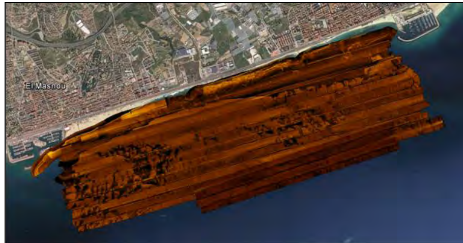
Figura 6.- Mosaico de los datos de sonar de barrido lateral en la zona de estudio (Fuente: Tecnoambiente)
