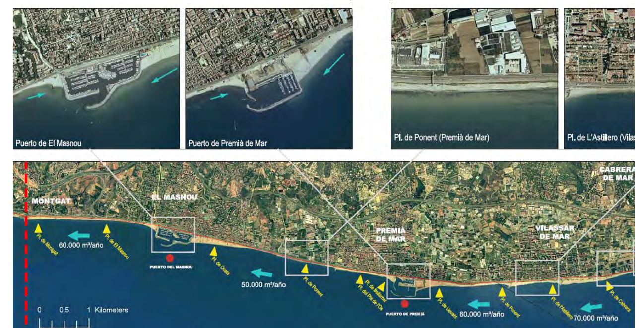
Figura 31.- Capacidad de transporte en la zona según el documento "Estrategia para la Sostenibilidad de la Costa" (Fuente: Dirección General de Sostenibilidad de la Costa y el Mar)
