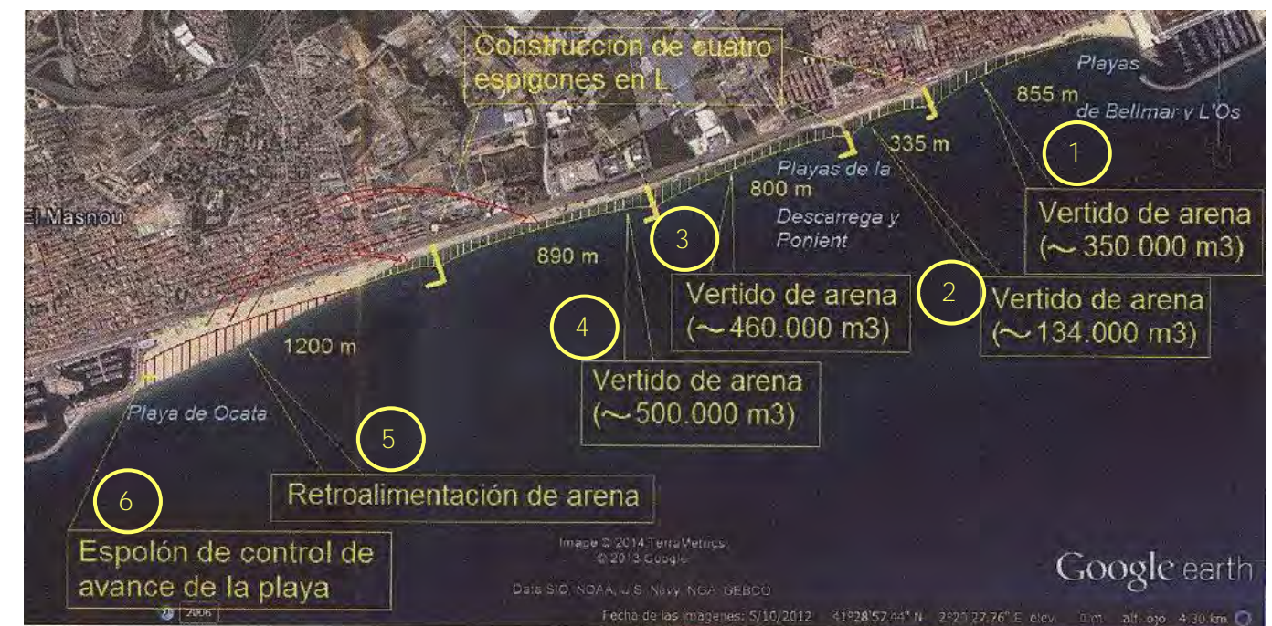
Figura 1.- Propuestas de actuación en el tramo entre los puertos de El Masnou y Premià sugeridas en el informe del CEDEX. (Fuente: CEDEX)
