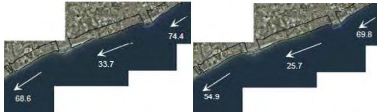
Figura 32.- Capacidad de transporte en la zona según el “ Libre verd de l'estat de la zona costanera a Catalunya ”; Izquierda: fórmula de Kamphuis; derecha: fórmula del CERC (Fuente: CIIRC / Generalitat de Catalunya)
