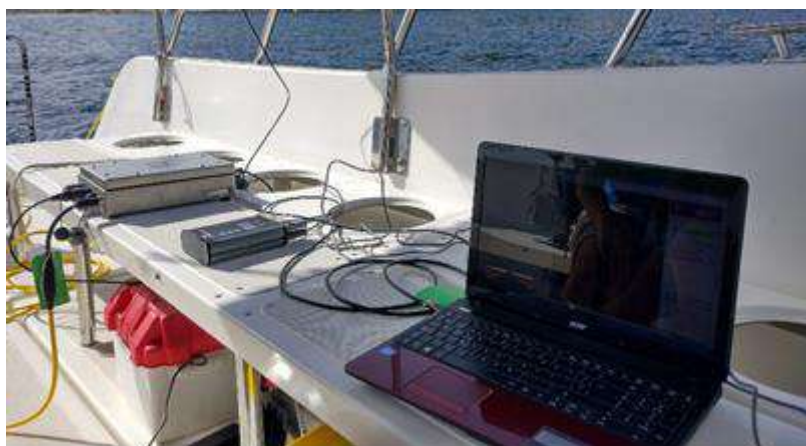
Figura 3: GPS Diferencial y equipos para la obtención, visualización y grabación en tiempo real de los sonogramas en campo. © OCEANSNELL
